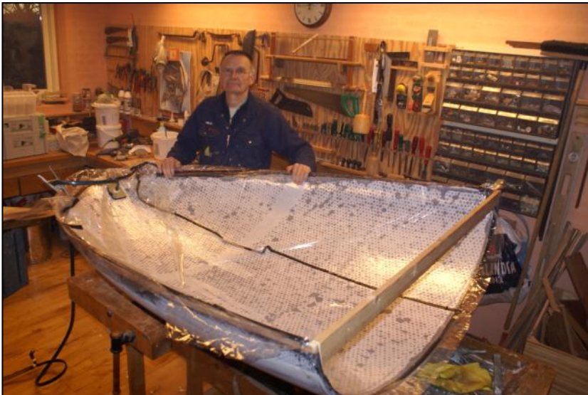
Ruffet støbes indvendigt – vakuum bagging
